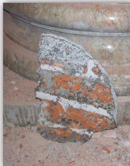
FIGURA 121 - PARTICOLARE DI UN PEZZO D'INTONACO TOLTO DALLA PARTE SOTTOSTANTE DELLA COLONNA
